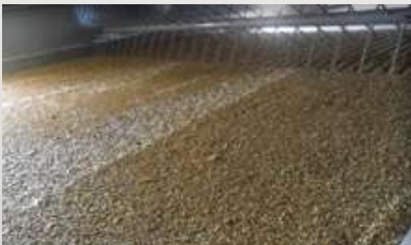
Impianto di essiccazione a ciclo continuo o alternato composto da 1 tappeto mobile, normalmente utilizzato con bassa temperatura dell'aria di processo e per piccole/medie capacità evaporative .
